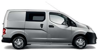
Kastenwagen mit zwei Schiebetüren sowie Teilverglasung und Heckscheibenwischer
