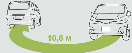
Der EVALIA hat einen beeindruckend engen Wendekreis von 10,6 Metern. In Verbindung mit der Gesamtlänge von gerade mal 4,4 m lässt er sich so einfach und sicher durch dichten Verkehr und in enge Parklücken manövrieren.
